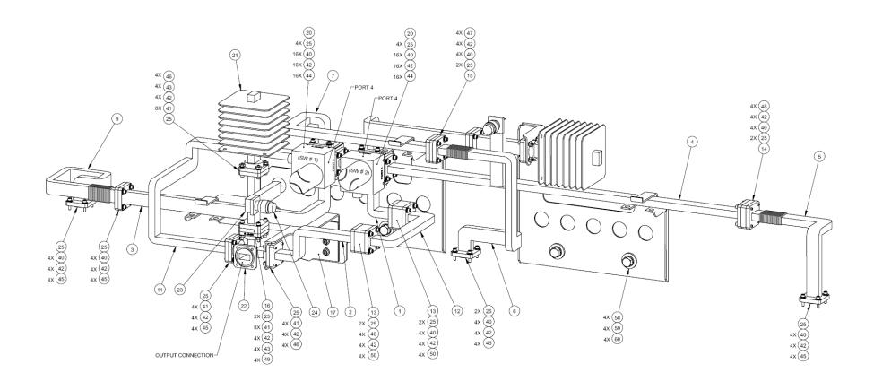
Figure A-7. Ku-Band 1:2 Waveguides and Components Kit (CEFD P/N KT-0000026) – Front View
