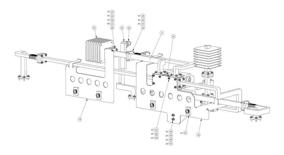
Figure A-8. Ku-Band 1:2 Waveguides and Components Kit (CEFD P/N KT-0000026) – Back View
