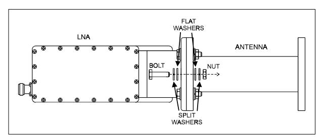
Figure 3-2. Installation of the LNA
