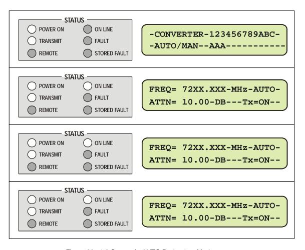
Figure 29. 1:3 System in AUTO Redundant Mode
